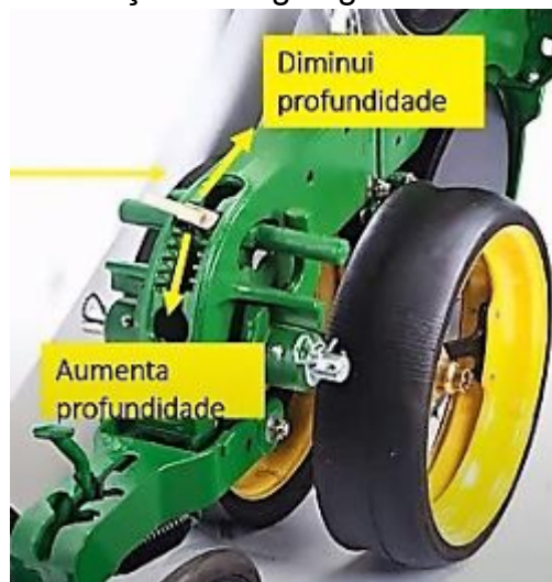
Figura 14 - Relação da regulação da roda limitadora
