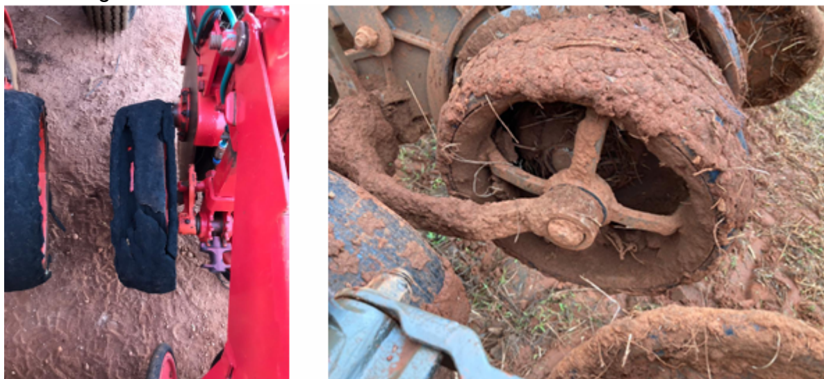
Figura 13 - Roda limitadora danificada e necessitando de ser trocada
